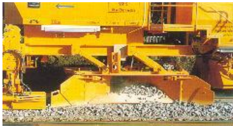
رگلاتور بالاست در هنگام جابجائی بالاست با تیغه های وسط (ریل پوشها)
